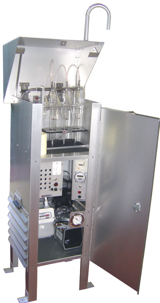
AMOSTRADOR DE PEQUENO VOLUME (APV) PARA A COLETA SIMULTÂNEA DE ATÉ TRÊS GASES
